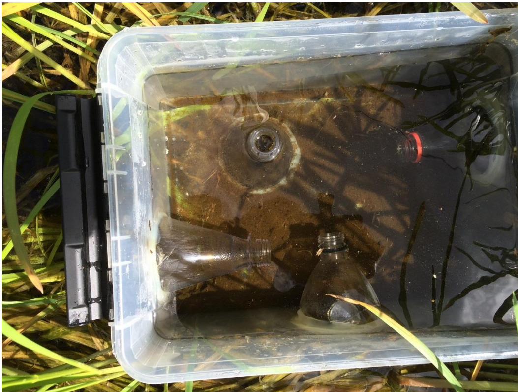
Bilde 4: Ortmanfelle satt ut i en av dammene, bilde tatt før lokk med flytelement ble påsatt
