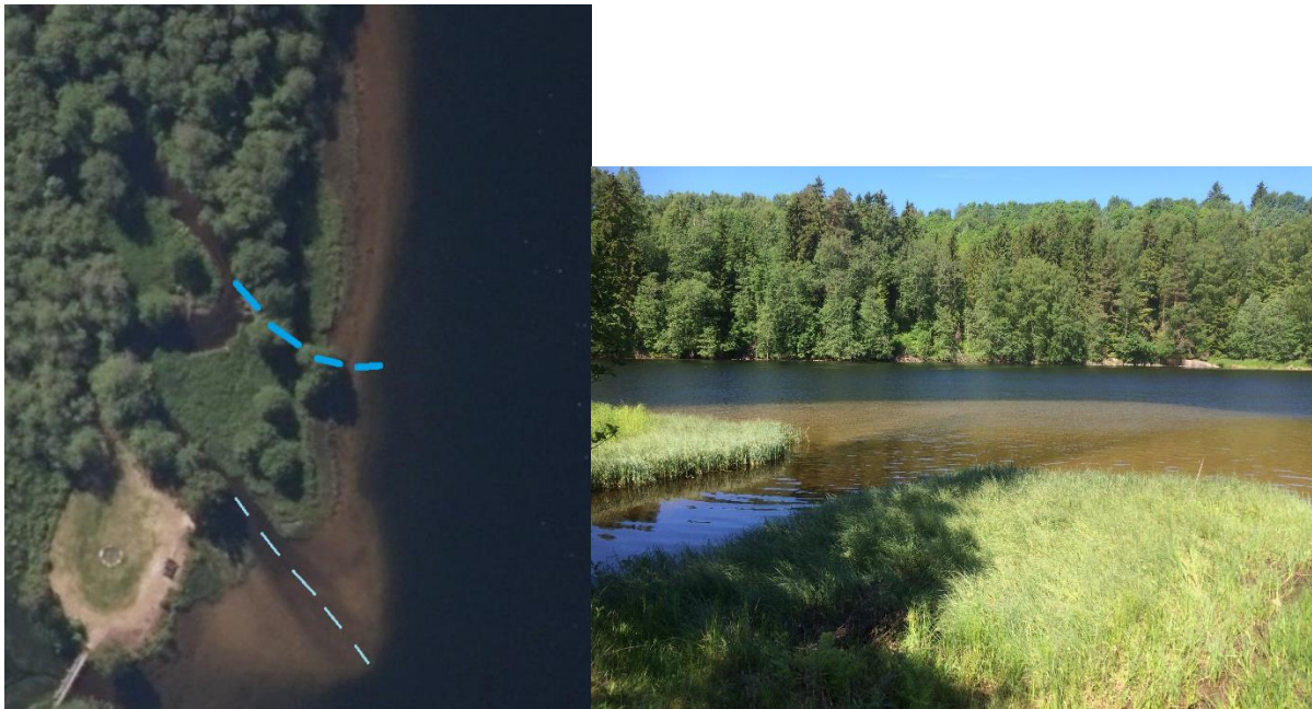
Bilde: Eksisterende grunne deltapregete utos merket med lyseblå stiptet linje. Nytt alternativt løp er merket med tykkere stiptet blå strek. Bildet til høyere viser det eksisterende utos Sauaråa.
