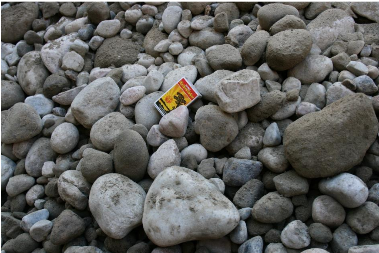
Bilde 2.1: Detaljbilde av utlagt gytegrus, naturgrus i fraksjon 20-100 mm.
