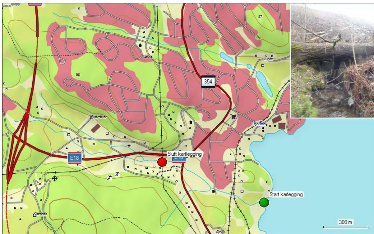
Bilde: Kartlagt strekning, bekken krysser under jernbane i smal steinsatt eldre kulvert.
